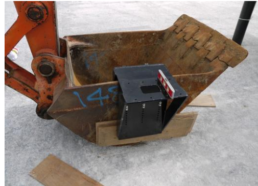
図-8 ソナー昇降装置取付金具のバックホウバケットへの取付状況
