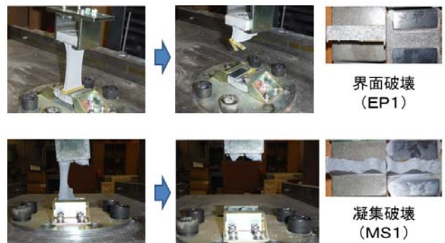
図-6 H 型供試体の接着引張試験の破壊状況例
