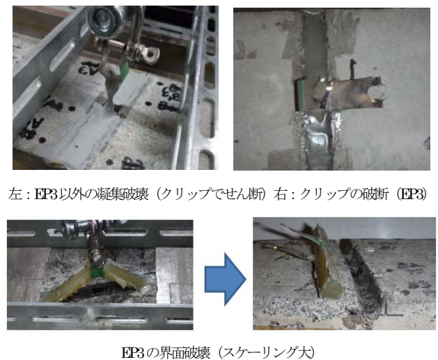
図-5 模擬充填供試体のクリップ接着引張試験状況
