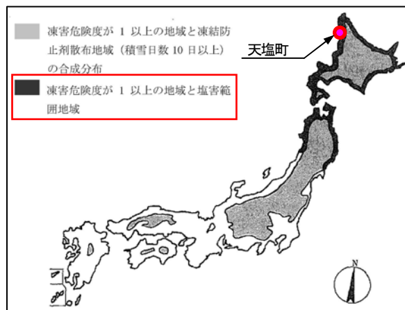
図-4 塩害と凍害による複合劣化の可能性がある地域 4)
