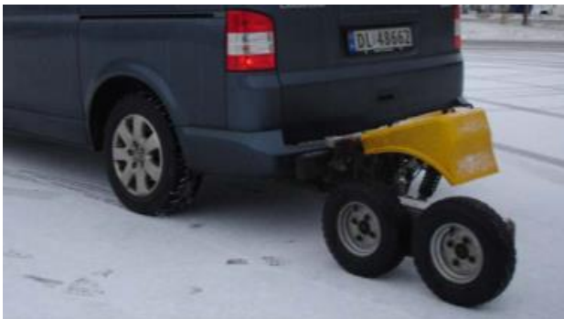
写真-3 牽引車後部に装着されたTWO
