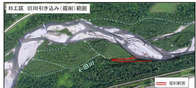
写真-4 旧川引き込み施工区・平面図
