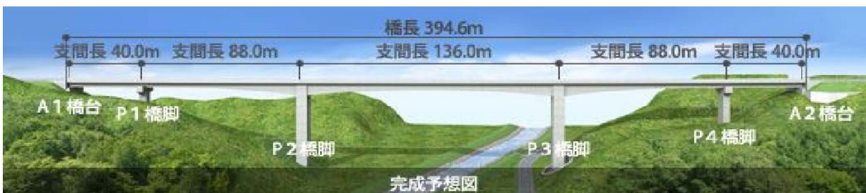
図-2 オビラシケ川橋側面概要図
