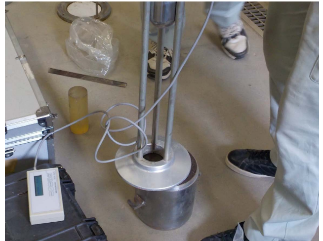
写真-1 室内における衝撃加速度試験
