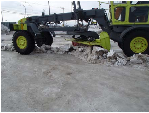
写真-4 除雪作業計測状況（路面整正装置稼働）
