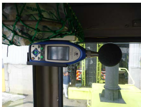
写真-2 精密騒音計 取付状況
