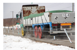
写真-2 ワイヤロープ式防護柵の性能確認試験
