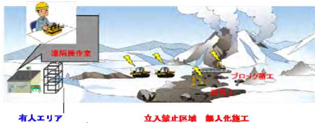
図-1 無人化施工イメージ
