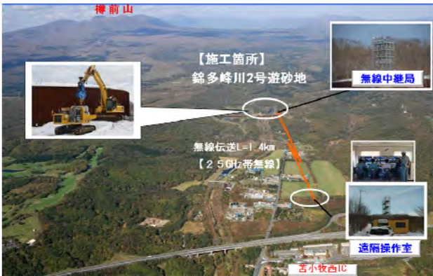
図-4 遠隔操作室—無線中継局間の無線
