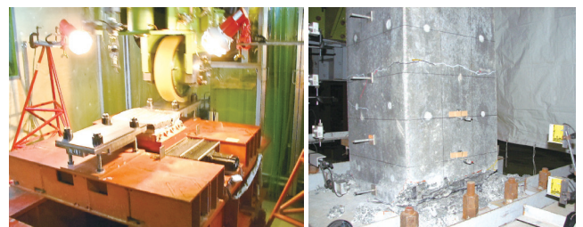
写真-2 防水工輪荷重試験 写真-3 橋脚正負交番試験
