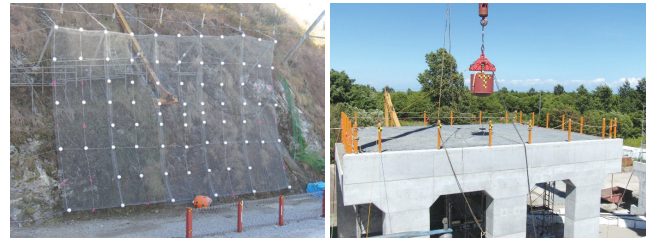
(a) ポケット式落石防護網 (b) RC製落石覆工 写真-1 実規模衝撃実験状況
