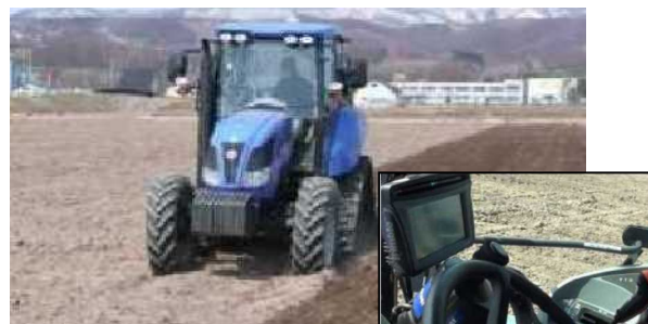
写真-7 自動操舵による耕起作業
