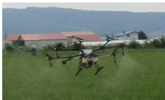
写真-6 防除用ドローンの農薬散布
