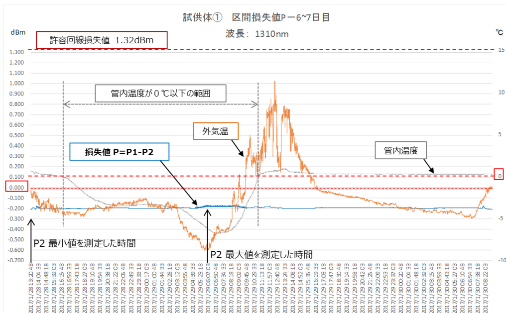
図-3 供試体①の管路内凍結時の通信量測定結果 (例)
