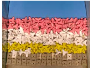
図-16 法止め対策した消波ブロック(実験後)
