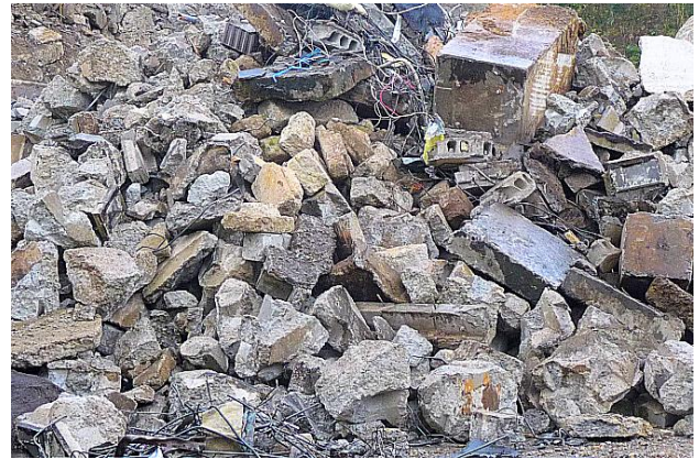
写真4 コンクリート殻の異物混入状況
