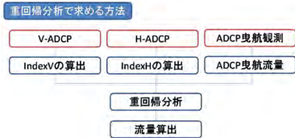
図-10 流量算出フロー：重回帰分析で求める方法
