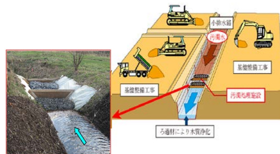
図-13 汚濁処理施設
