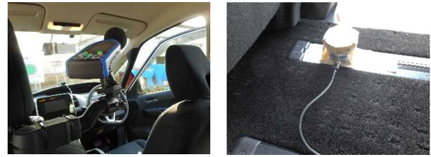
図-10 車内騒音(左)・車内振動(右)の測定状況
