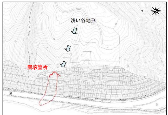
図-2 崩壊箇所周辺の地形状況
