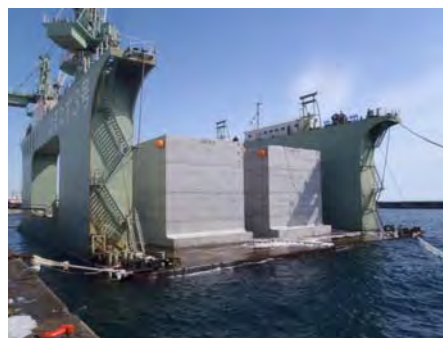
写真-1 ケーソン製作用台船
