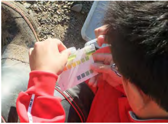
写真-10 カラーチャートと見比べて pH を測定
