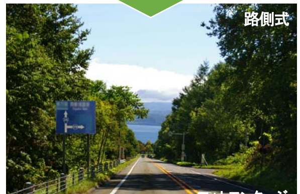
写真-5 前方に向けた視界への阻害が少ない路側式
