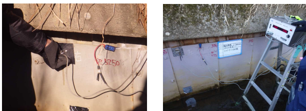
写真-5 塗膜インピーダンス試験状況
