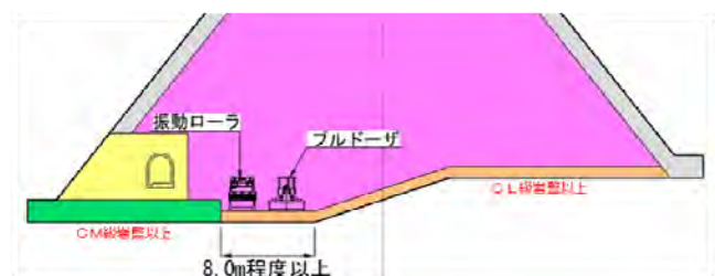
図-6 設計の見直し内容（基礎掘削形状）
