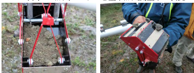
写真-8 サンプラー本体と粘着テープによる採取
