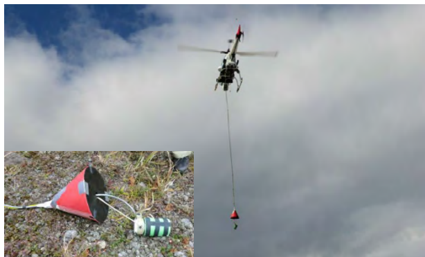
写真-7 磁気センサーと空中磁気測量中の状況
