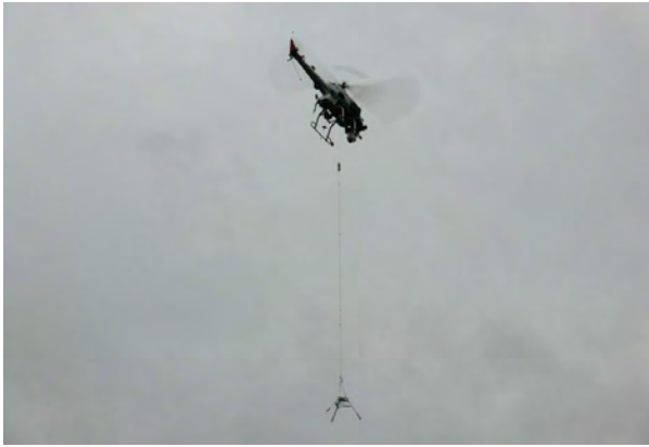
写真-11 振動センサーを吊り下げた状態
