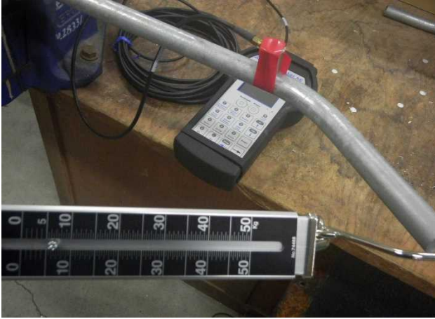
写真-7 照明柱モデルでの計測状況
