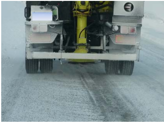
写真3 加熱水散布機構を用いた散布状況
