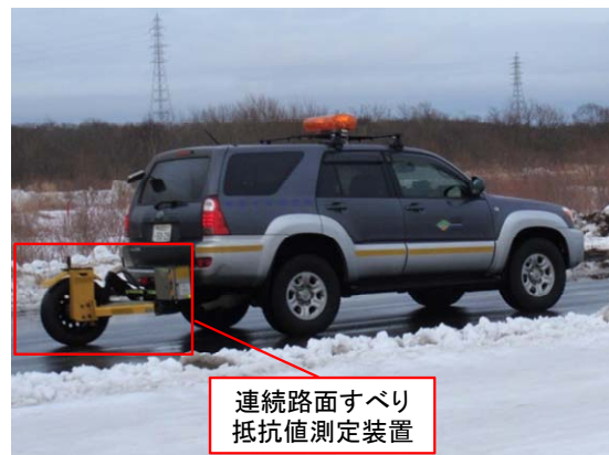
写真-2 連続路面すべり抵抗値測定装置
