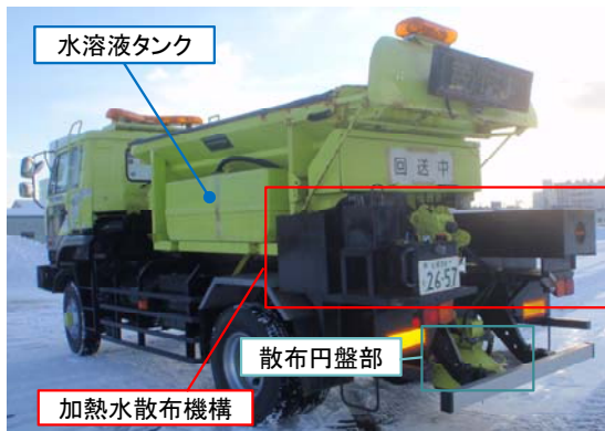
写真-1 試作した加熱水散布機構
