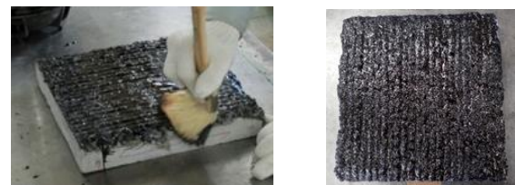
(a) 防水材塗布(刷毛) (b) 防水材塗布後
