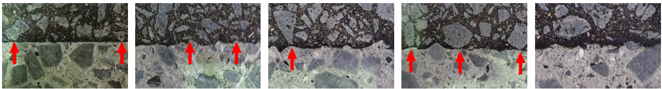
(a) ケース1 (b) ケース2 (c) ケース3 (d) ケース4 (e) ケース5 ↑：骨材の平板までの到達が予測される箇所
