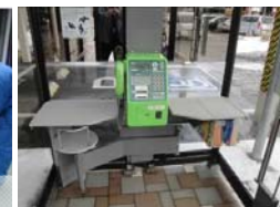
写真-5 災害時につながりやすい公衆電話
