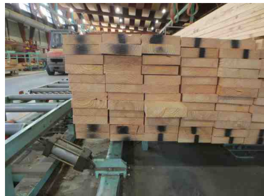
図-1 集成材工場の接着前ラミナ集積状況
