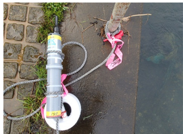
写真-2 超音波受信機 河川内に沈めて設置
