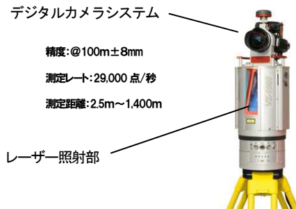
図-5 三次元レーザスキャナ本体
