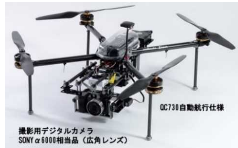
図-3 空中写真撮影に用いたドローン
