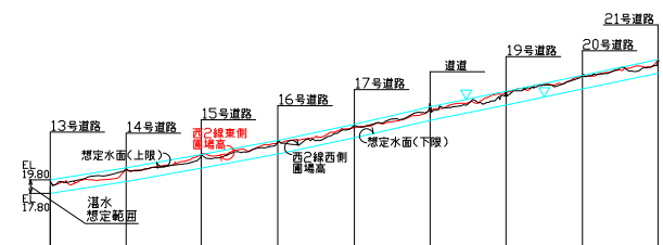
図-9 湛水縦断面図
