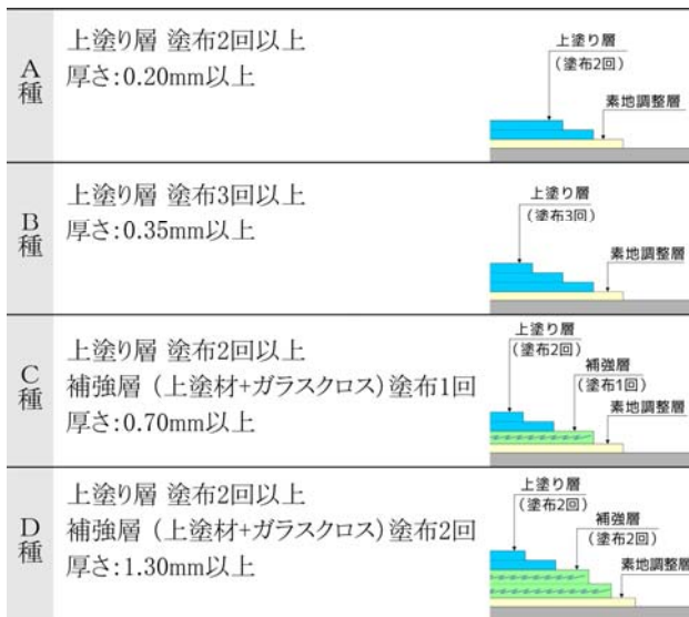
図4 供試体の各規格における防食塗装の概要
