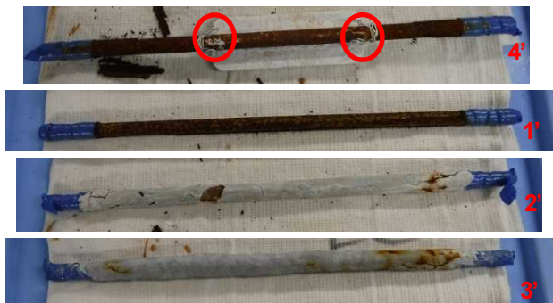
写真-8 暴露後の鉄筋外観 （上から犠牲陽極、無処理、防錆剤、塩分吸着剤）
