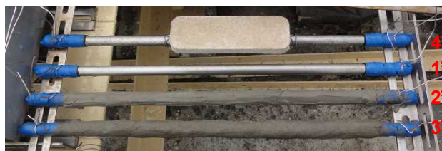
写真-7 各鉄筋暴露状況（暴露直後） （上から犠牲陽極、無処理、防錆剤、塩分吸着剤）
