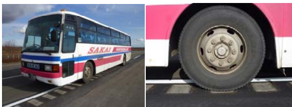
写真-1 大型車対応ランブルストリップス
