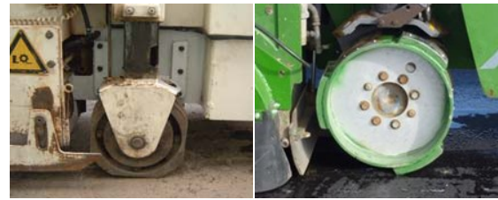
写真-2 異径車輪（左）と突起型車輪（右）
