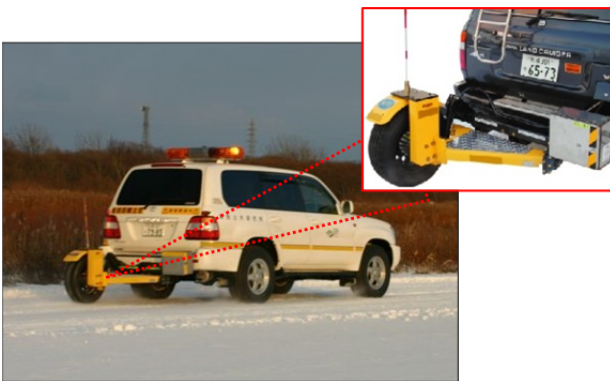
写真-1 連続路面すべり抵抗値測定装置（CFT）
