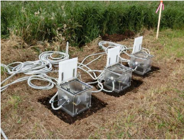
図-2 チャンバー設置状況 (暗渠なし区)
