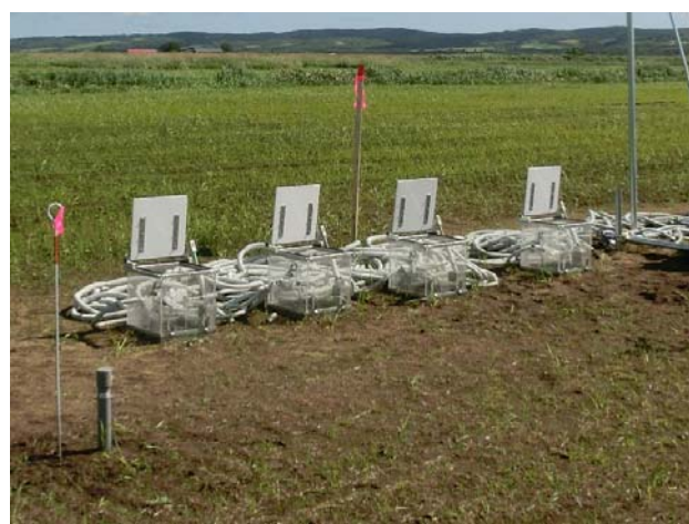
図-1 チャンバー設置状況（暗渠あり区）
