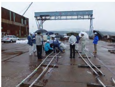
写-15 撤去ロープの外観観察
