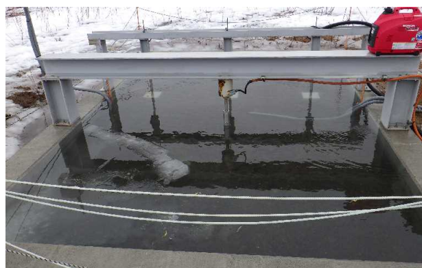
写真-5 土槽の滞水の状況 (3月9日午前)
