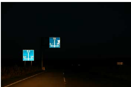
写真-11 夜間の視認性確認状況(前照灯上向き)
