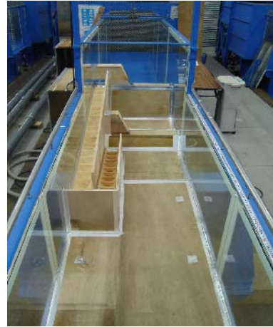
写真1 実験に用いた折り返し魚道模型
