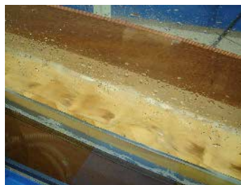
写真3 魚道内を射流で流下する流況 ( d_c/h = 0.195 , S/h=1.00 , L_f/b=0.90 )
