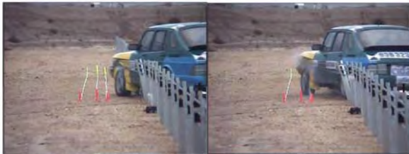
写真-3 ワイヤーロープ式防護柵の衝突実験状況 5)
