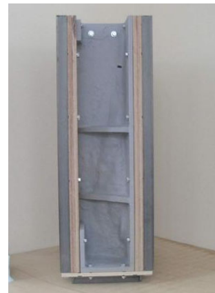
写真-3 模型型枠
