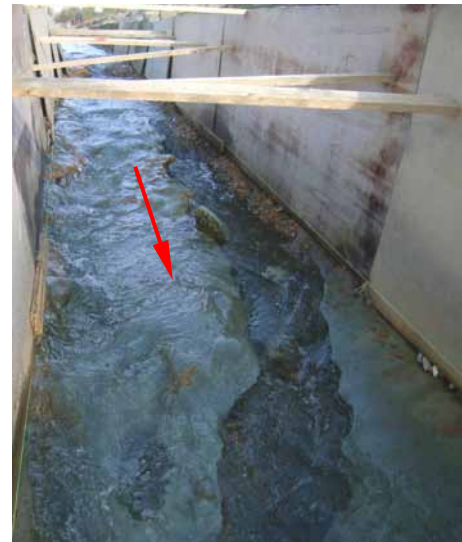
写真-6 実験終了後の水路（おう穴、みずみちの形成）
