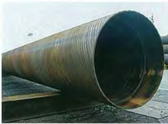
写真-2 外面突起付き鋼管
