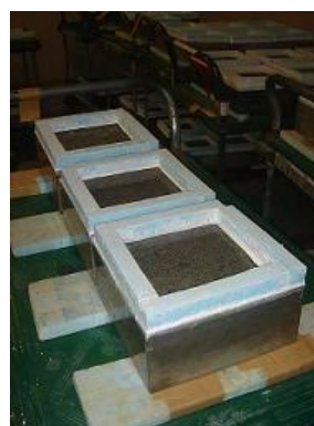
写真-1 ASTM C 672に準じた供試体
