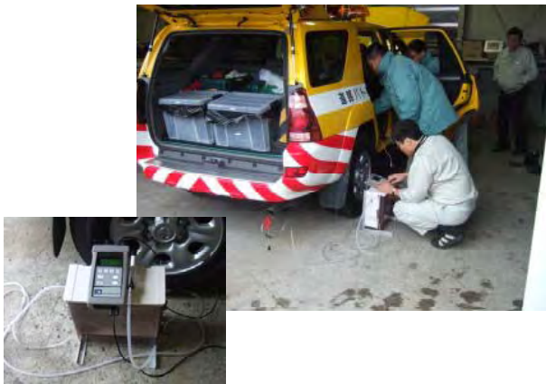
写真-6 「Auto5.1」(自動車排ガス分析計)による測定状況
