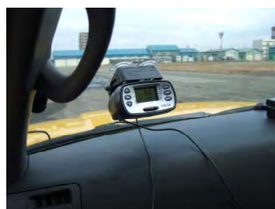
写真-4 「VBOX」(GPS式速度距離測定装置) 装着状況
