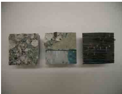
写真-14 母材の破壊状況
