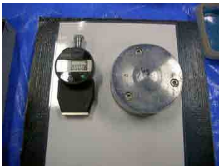
写真-8 使用した硬度計と重錘
