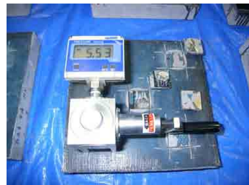
写真-11 付着強度試験
