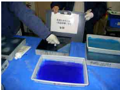
写真-13 冬用エポキシ樹脂 ( -5^{\circ}\text{C} ) 3日後未硬化
