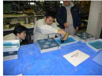
写真-9 ポータブル硬度計貫入試験状況
