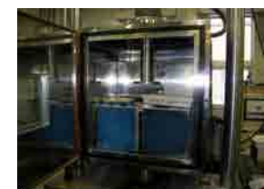
写真-7 極低温養生 (-15℃) の状況
