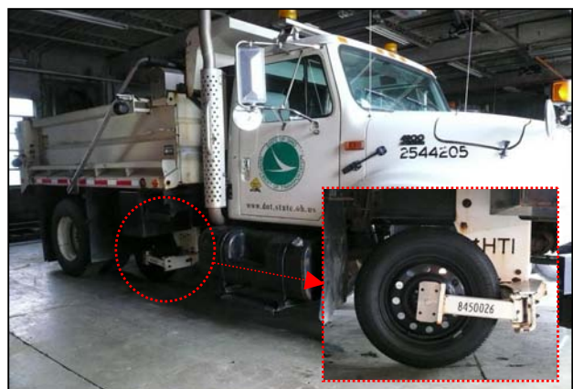
写真-4 除雪・散布車両に取り付けられたCFT (ODOT)
