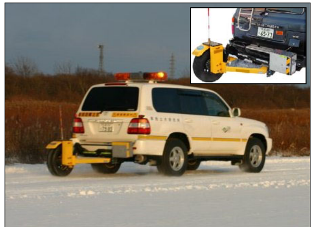
写真-3 連続路面すべり抵抗値測定装置（CFT）
